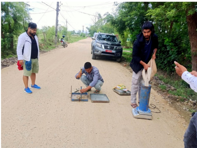
सडक निर्माणका लागि ल्याब परिक्षण कार्यको स्याम्पलींग लिईदै ।
